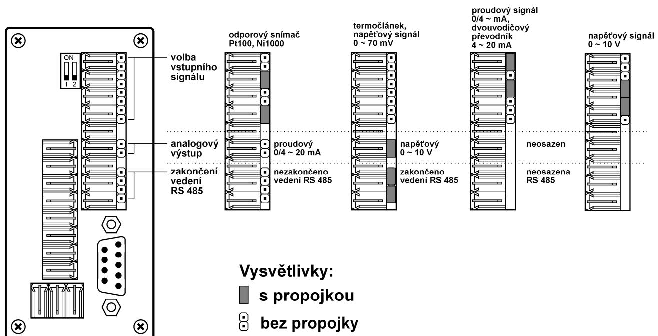
Při volbě typu vstupního signálu a typu analogového výstupu nutno respektovat nastavení propojovacího pole při zadávání parametrů v programovacím módu.
