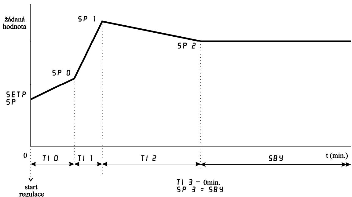
$SP_0, SP_1, SP_2, SP_3\dots$  žádané hodnoty regulované veličiny pro příslušné fáze programu
