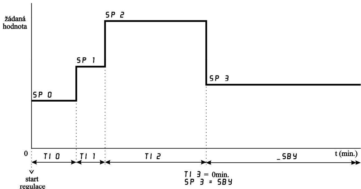
$SP_0, SP_1, SP_2, SP_3\dots$  žádané hodnoty regulované veličiny pro příslušné fáze programu
